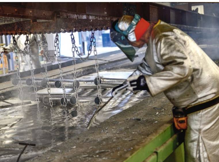
■ Figure 12. Port de tenue protégeant contre la chaleur, gants et cagoule avec écran facial par un opérateur travaillant dans un atelier de galvanisation
