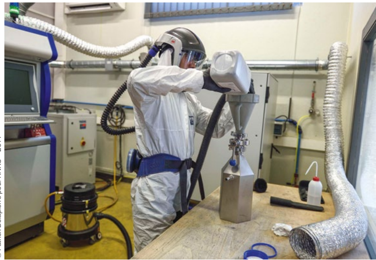
■ Figure 18. Port de vêtement de protection contre les risques électrostatiques, gants et casque à ventilation assistée par un opérateur travaillant en zone ATEX
