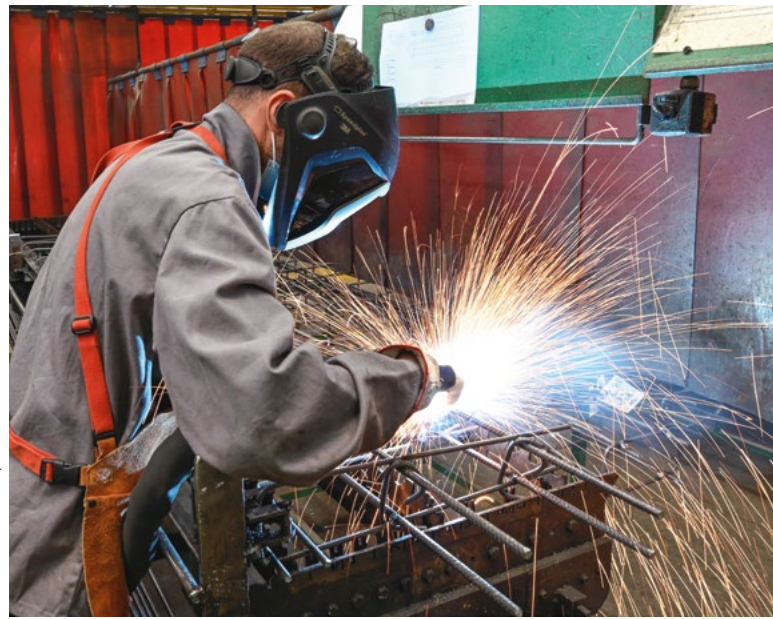
■ Figure 13. Port de tablier, écran facial et gants lors d'opérations de soudage
