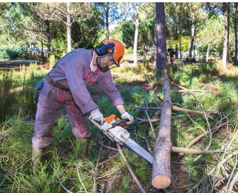
■ Figure 4. Port de vêtement de protection pour les utilisateurs de scies à chaîne tenues à la main, gants, casque et visière lors d'activité de bûcheronnage
