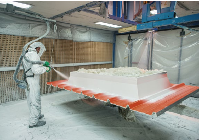
■ Figure 15. Port de vêtement étanche aux brouillards, gants et casque à adduction d'air lors d'opérations de gelcoatage
